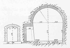
Fig. 15. - Dans les terrains détritiques. - 1:150
