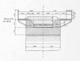
Fig. 9. - Coupe transversale sur la clé de voûte. - 1 : 200.
