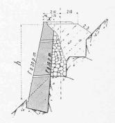
Mur de soutènement à mortier. -1:100.  $x = 0.15 \ h \ pour \ h > 3 \ m.$
