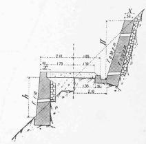
Murs de soutènement et de revêtement à mortier. - 1 : 150.  $x = 0.25 \ h \ et \ge 0.50 \ pour \ h < 3 \ m$ .  $X = 0.14 \ H \ et \ge 0.60.$
