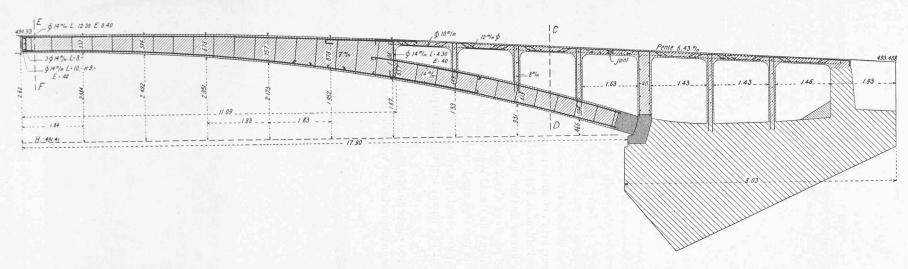
Fig. 7. — Coupe en long de la moitié (rive droite) de l'arc. — Echelle 1 : 100. N.-B. — L'articulation à la naissance, formée de deux pierres en granit, est indiquée par des hachures serrées.
