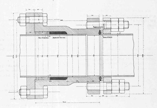
Fig. 5. - Manchon spécial pour ajustage pour tuyaux Mannesmann de 150 mm.
