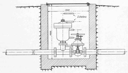
Fig. 4 a. -- Chambre de soupape automatique combinée avec une vanne d'arrêt.
