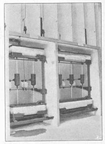
Fig. 47. — Résistances hydrauliques à jet d'eau.
