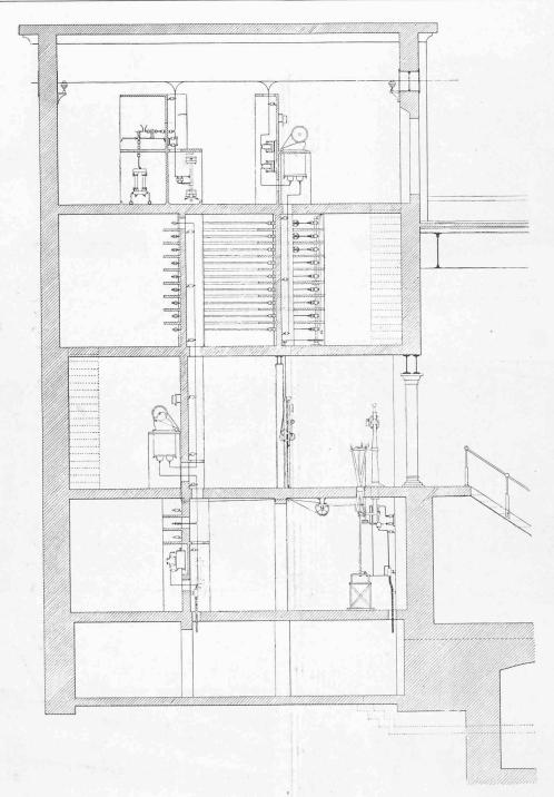
Fig. 38. — Section transversale de l'annexe du tableau.
