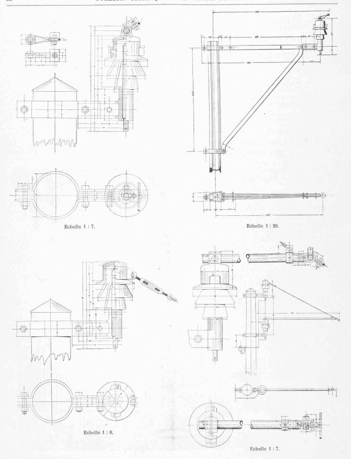
Fig. 8, 9 et 10. — Suspension du fil de contact. — Prise de courant sur le côté.
