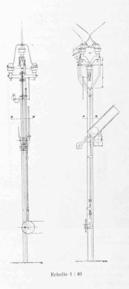
Fig. 18 et 19. - Interrupteur à cornes.
