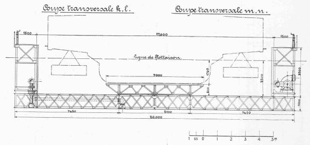
Fig. 4. - Coupe transversale du dock flottant d'Ouchy.
