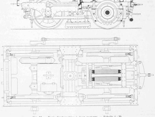
Fig. 42. — Bogie d'automotrice à deux moteurs. — Echelle 1 : 30.
