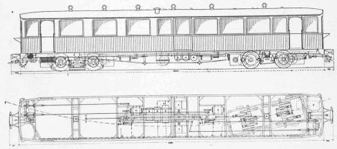
Fig. 41. - Automotrice à quatre moteurs.
