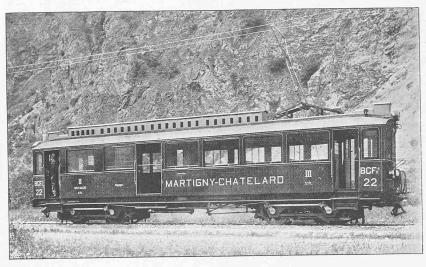
Fig. 43. - Automotrice à deux moteurs
