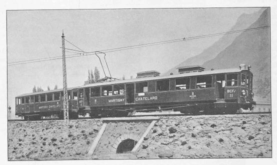
Fig. 48. — Train composé d'une automotrice à quatre moteurs et d'une voiture remorquée.
