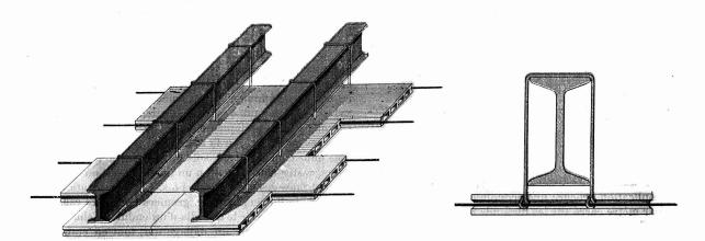
Plafond-hourdis en construction sur poutrelles en fer
