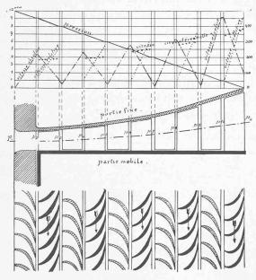
Fig. 15. - Turbine à réaction à 5 chutes de pression.
