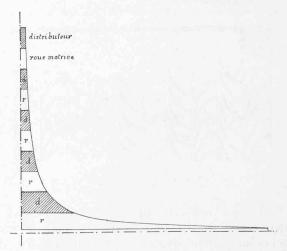
Fig. 14. — Turbine à réaction à 5 chutes de pression.
