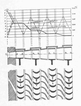
Fig. 13. - Turbine d'action à 4 chutes de pression.
