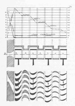
Fig. 16. — Turbine d'action à 4 chutes de vitesse.
