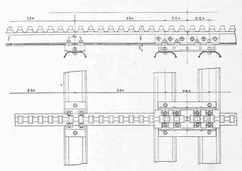
Fig. 29. - Joint de crémaillère (système Strub).
