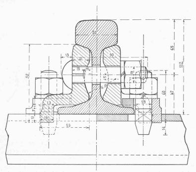
Fig. 26. - Voie avec traverses métalliques.
