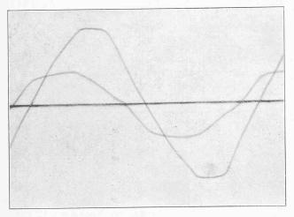
Fig. 51. — Courbes de la tension et du courant d'un générateur. — Locomotive Nº 2 à vide, 42 kilomètres à l'heure. — Moteurs avec nouveaux induits à rainures fermées obliques sur Γaxe.
