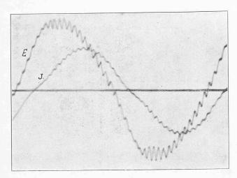
Fig. 49. — Courbes de la tension et du courant de deux générateurs en parralèle. — Locomotive Nº 2 avec train de 450 tonnes, 22 kilomètres à l'heure, 39 oscillations par période. — Moteur avec anciens induits à rainures ouvertes parallèles à l'axe.
