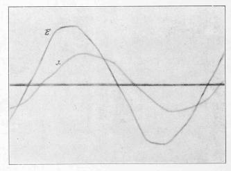
Fig. 52. — Courbes de la tension et du courant d'un générateur. — Locomotive Nº 2 avec train de 50 tonnes, 43 kilomètres à l'heure. — Moteurs avec nouveaux induits à rainures fermées obliques sur l'ave.
