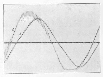
Fig. 50. — Courbes de la tension et du courant de deux générateurs en parallèle. — Locomotive N° 2 avec train de 450 tonnes, 37 kilomètres à l'heure, 64 oscillations par période. — Moteurs avec anciens induits à rainures ouvertes parallèles à l'axe.
