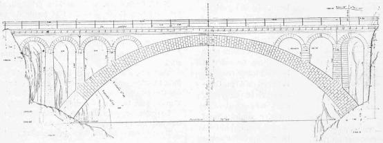
Fig. 11. - Viaduc du Triège. - Elévation.
