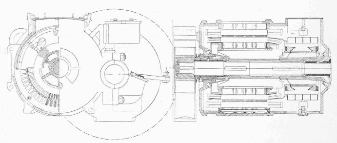
Fig. 44. — Moteur monophasé à collecteur de 220-250 HP de la locomotive Nº 3.
