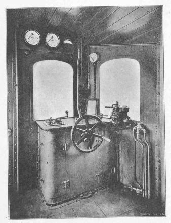
Fig. 42. — Cabine de la locomotive Nº 3 avec un des manipulateurs de commande et les appareils de mesure.
