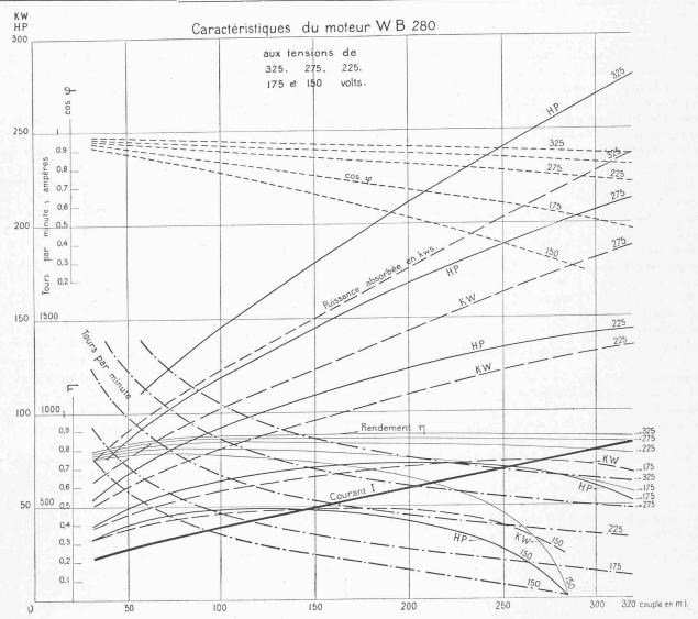
Fig. 45. — Caractéristiques de fonctionnement du moteur de 220-250 HP de la locomotive Nº 3.
