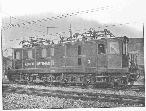
Fig. 40. — Locomotive de 1000-1500 HP à 6 essieux moteurs.
