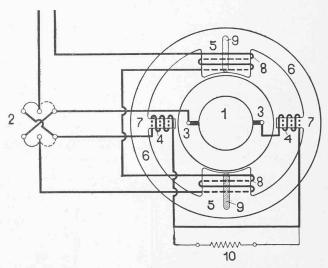
Fig. 38. — Schema des connexions des enroulements du moteur monophasé à collecteur de 250 HP.
