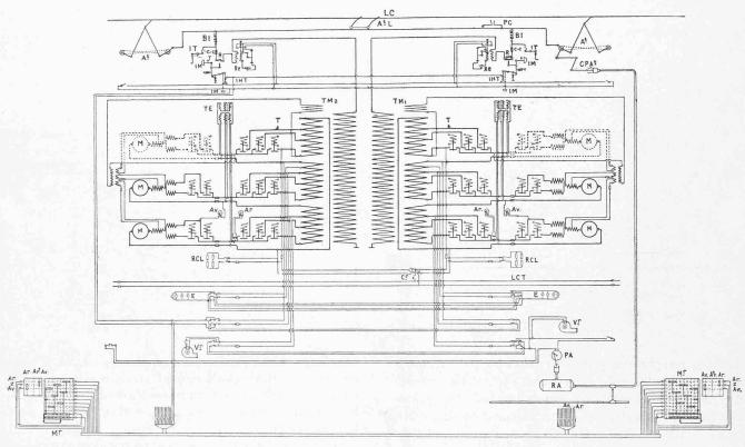
Fig. .41 — Schéma électrique de la locomotive Nº 3.
