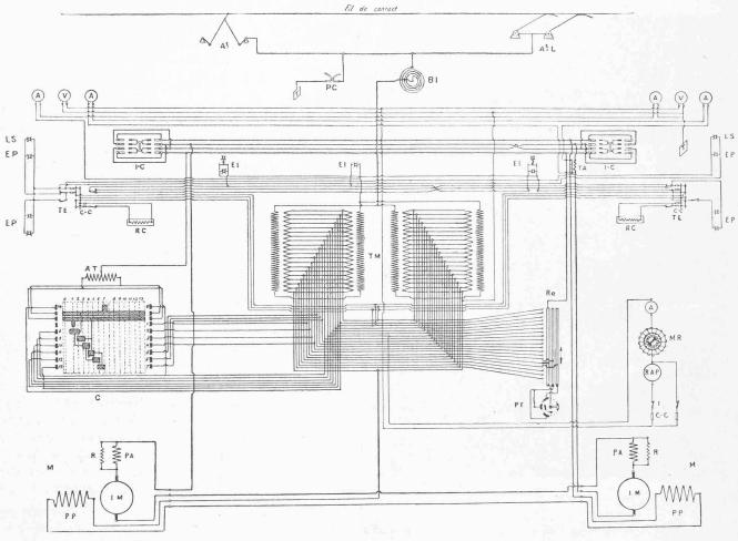
Fig. 34. — Schéma électrique de la locomotive monophasée Nº 2.
