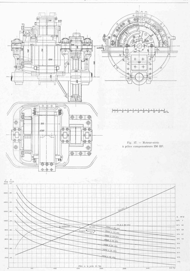
Fig. 39. — Caractéristique de fonctionnement du moteur monophasé à collecteur de 250 HP.
