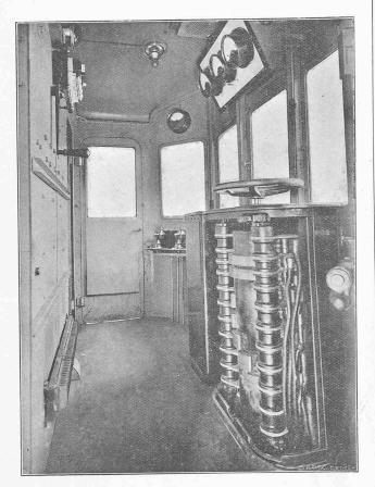
Fig. 35. - Cabine avec instruments de mesure et controller ouvert.
