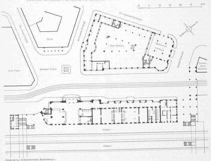
Plan de situation et plans du rez-de-chaussée des divers bâtiments. — 1 : 1000.
