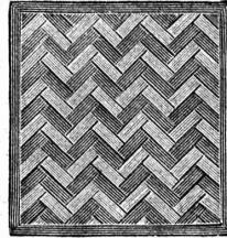
Vissé sur faux ou vieux plancher, rendu posé au bain de mortier de silicate de soude sur béton en ciment Portland,
