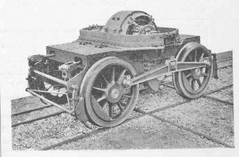
Fig 31. — Bogie de la locomotive transformatrice avec moteur à courant continu de 250 HP.
