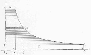
Fig. 5. — Diagramme d'une turbine à vapeur idéale.
