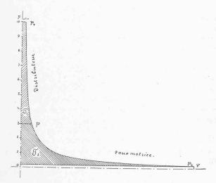
Fig. 10. — Diagramme d'une turbine simple à réaction.
