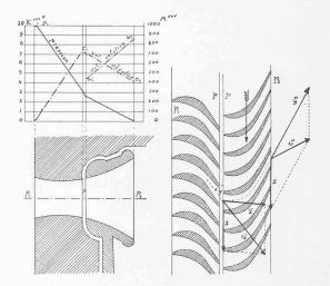
Fig. 41. - Turbine simple à réaction.
