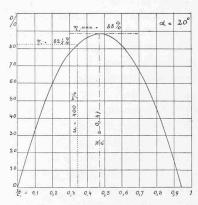
Fig 9. - Rendement d'une turbine simple d'action.
