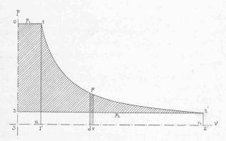
Fig 4. - Diagramme d'une machine à vapeur idéale.
