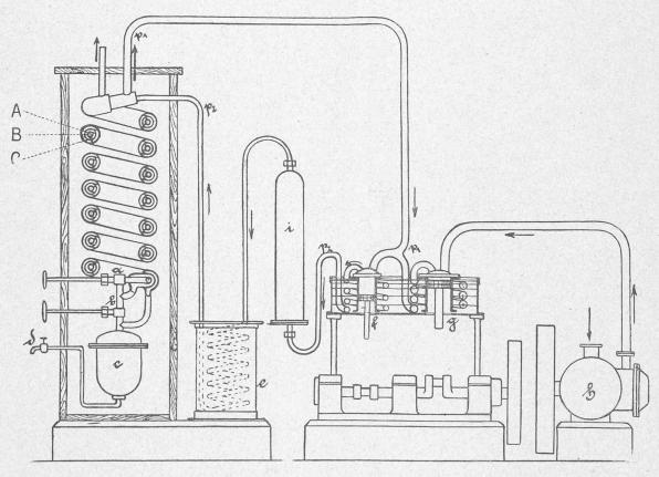
Fig. 1. — Machine de Linde.
