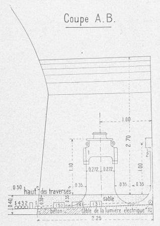
Fig. 10 bis. - Position des boîtes dans les niches du tunnel.
