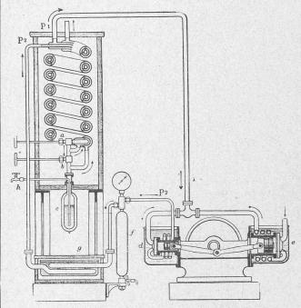
Fig. 2. — Machine de Linde, type de laboratoire.
