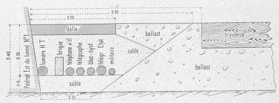
Fig. 6. - Position des càbles dans le tunnel.
