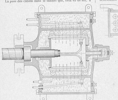
Fig. 9. — Boîte d'extrémité pour câbles à faible courant.
