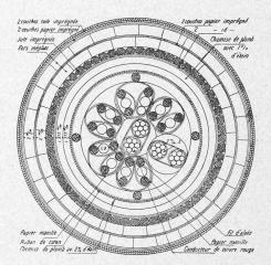
Fig. 2. — Càble pour le téléphone et les cloches.
