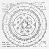
Fig. 3. — Câble pour le bloc-système. Partie Nord.
