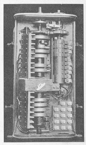
Fig. 32. — Controller ouvert, type « Electricité et Hydraulique », de Charleroi.
