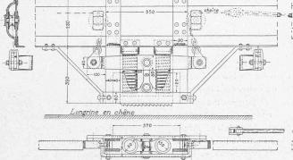
Fig. 28. — Frein de sûreté des voitures de la ligne de la Pontaise.
