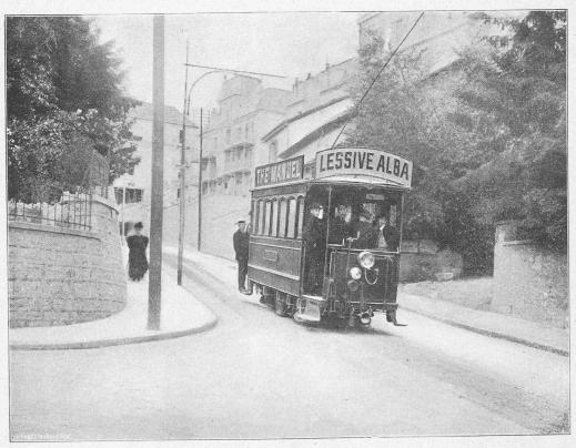
Fig. 27. — Voiture de la ligne de la Pontaise sur rampe de 113  $^{\circ}/_{\circ 0}$ .
