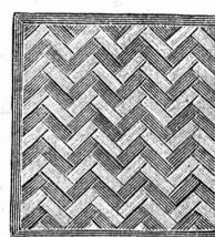
Vissé sur faux ou vieux plancher, rendu posé au bain de mortier de silicate de soude sur béton en ciment Portland, ou béton en scorie, selon tous les dessins : carré, octogones, etc., en quatre couleurs et en forme de fougères (bâtons rompus).
