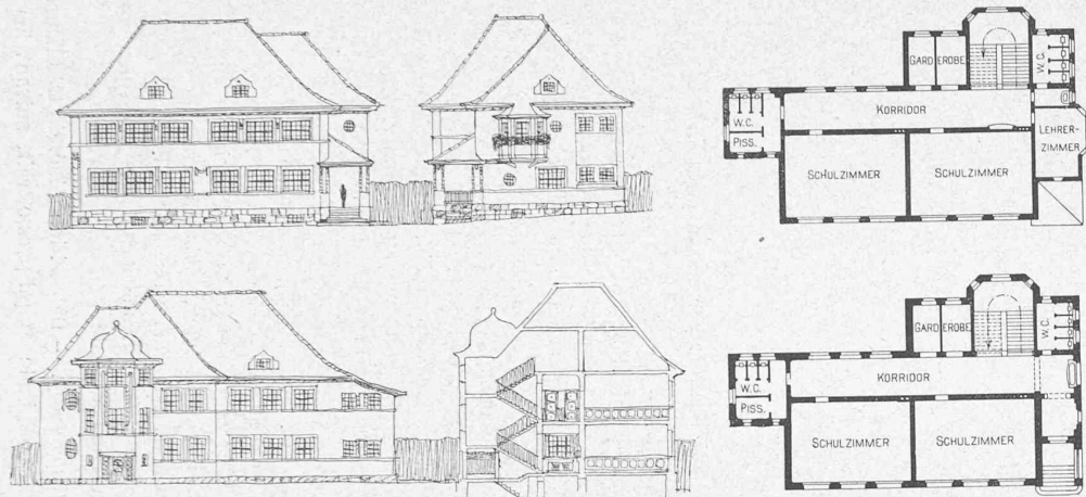
Façades, coupes et plans d'un pavillon. — Echelle 1 : 600.
