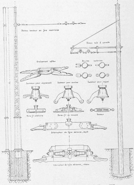
Fig. 14. — Matériel d'appareillage des lignes aériennes établies en 1903.
