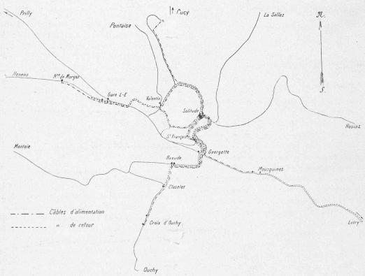
Fig. 12. — Schéma des càbles d'alimentation et de retour.
