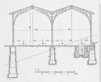
Fig. 49. — La remise des voitures des Tramways lausannois à la Solitude, pendant la I<sup>∞</sup> période d'exploitation (1895-1903). — Coupe transversale.
