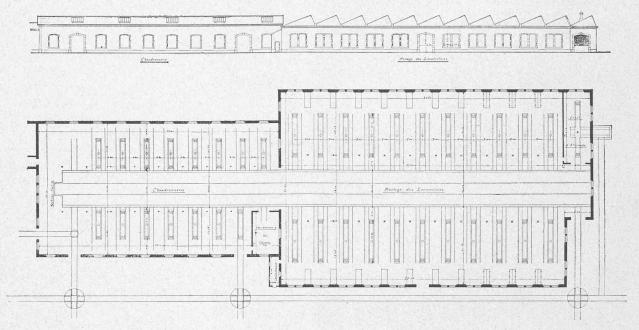
Fig. 45. — Chaudronnerie et montage des locomotives.
