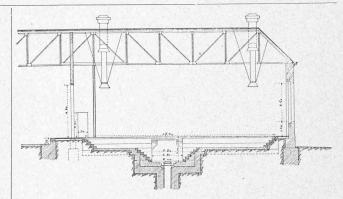
Fig. 48. — Local d'allumage des locomotives et fosse à descendre les essieux.
