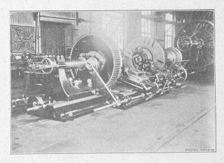
Fig. 3. — Tour à roues de vagons actionné directement par un moteur de 45 HP.
