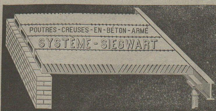
Le plus ancien et plus éprouvé des systèmes de béton armé, fabriqués machinellement.
