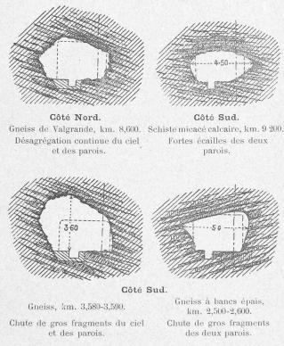
Fig. 4. – Profils déformés de la galerie parallèle sans revètement.
