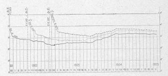
Fig. 54. — Refroidissement progressif du rocher dans la galerie parallète et son réchauffement à la suite du passage dans cette galerie des eaux chaudes de l'avancement.
