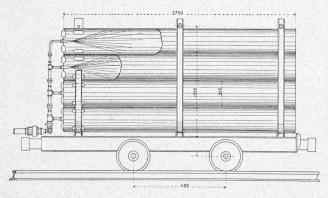
Fig. 46. — Appareil de réfrigération formé de 12 injecteurs montés sur un truc de wagonnet. Vue longitudinale.
