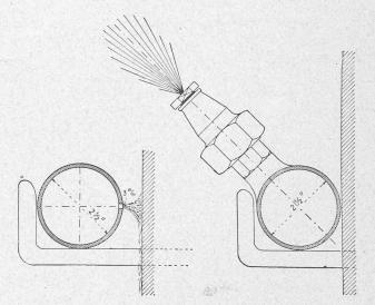
Fig. 52. – Tuyau percé aspergeant les piédroits du tunnel.
