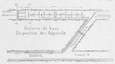
Fig. 42. — Groupe de 42 pulvérisateurs Westfalia placés en avant des chantiers d'élargissement du côté de Brigue.
