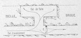
Fig. 21. — Ventilation de la galerie de faite au moyen d'un écran mobile E placé dans la galerie de base.
