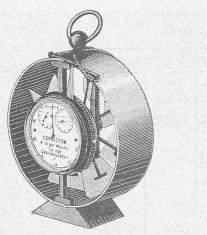
Fig. 49. — Anémomètre permettant de mesurer la vitesse de l'air de 0m,50 à 12 m. à la seconde.
