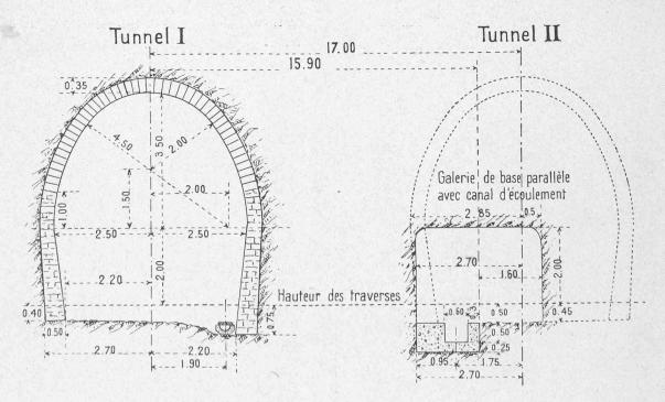
Fig. 2. — Tunnel du Simplon. — Profil-type du tunnel I et galerie parallèle avec canal d'écoulement.
