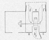
Fig. 16. — Aspiration de l'air du tunnel.
