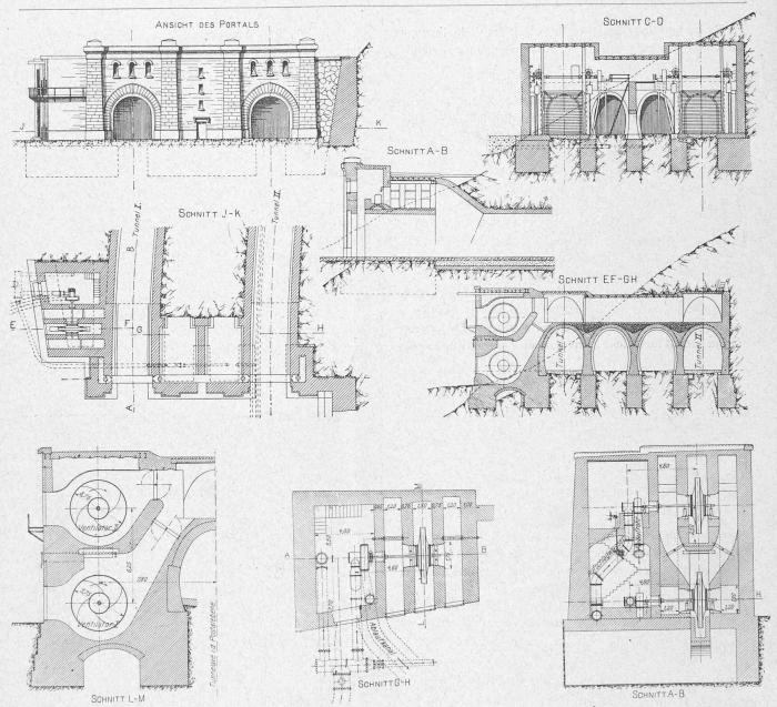
Fig. 5 à 42. — Elévation, plan et coupes des installations de la ventilation du tunnel, côté de Brigue. Clichés de la « Schweizerische Bauzeitung ».
