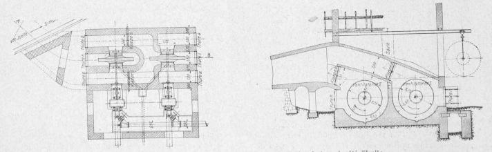
Fig. 13 et 14. — Plan et coupe des installations de la ventilation du tunnel, côté d'Iselle. Clichés de la « Schweizerische Bauzeitung ».
