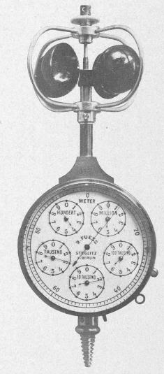
Fig. 20. — Auémomètre permettant de mesurer la vitesse de l'air de  $0^{\rm m}$ ,50 à 50 m, à la seconde.
