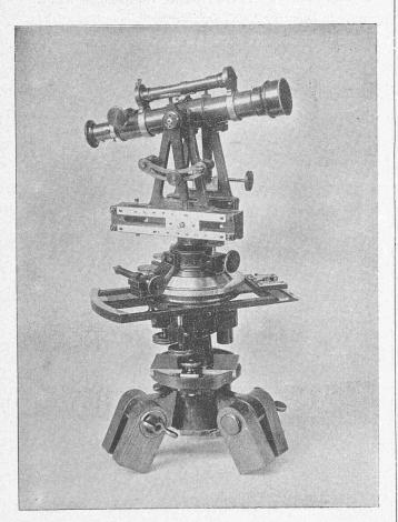
Fig. 6. — Tachéomètre Mayer et Wiesmann. — Modèle Nº III.
