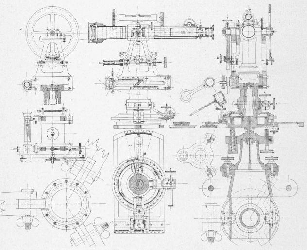
Fig. 4. — Elévation, coupes et plan du Tachéomètre Mayer et Wiesmann. — Modèle  $N^o$  III.
