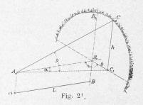
La projection du point C sur le plan horizontal est déterminée par la relation  $B_4$   $C_4 = b = L$  tg  $\alpha$ . Mais nous ne connaissons, jusqu'à maintenant, que la distance L, la valeur tg  $\alpha$  sera donnée par l'instrument.
