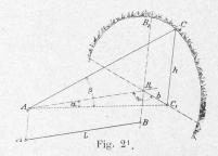
La projection du point C sur le plan horizontal est déterminée par la relation  $B_4$   $C_4 = b = L$  tg  $\alpha$ . Mais nous ne connaissons, jusqu'à maintenant, que la distance L, la valeur tg  $\alpha$  sera donnée par l'instrument.
