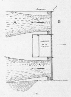
Fig. 1. - Disposition générale des expériences faites à l'usine de Vessy sur l'Arve.
