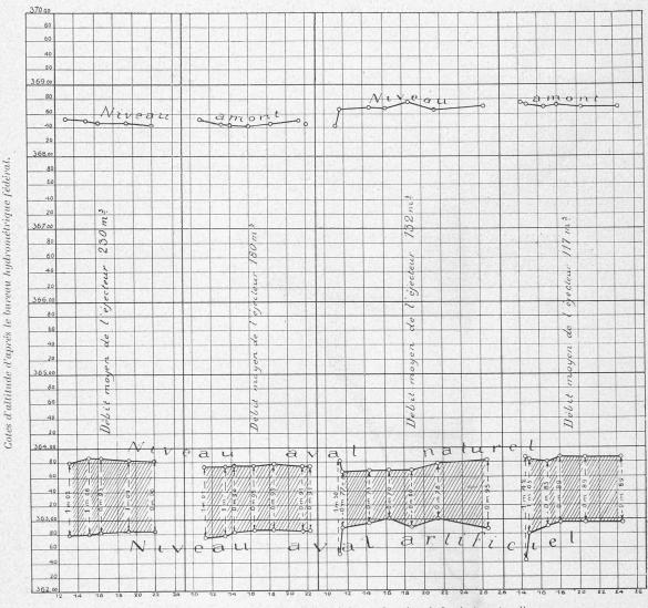
Fig. 6. — Abaque donnant la chute récupérée, en fonction de la chute naturelle, du débit de la turbine et de celui des éjecteurs.
