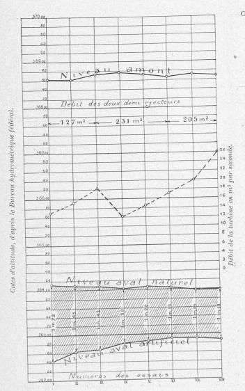
Fig. 3. — Graphique donnant la chute récupérée en fonction des débits des éjecteurs et de la turbine, et de la chute naturelle. (La ligne ponctuée donne le débit de la turbine).
