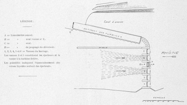
Fig. 1. — Disposition générale des expériences faites à l'Usine de Chèvres, près Genève. — Echelle : 1 : 2000.
