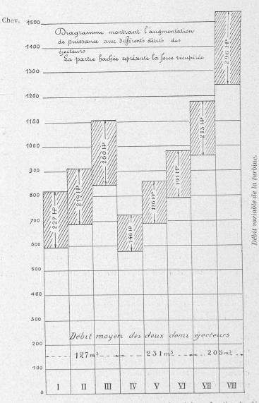
Fig. 4. — Graphique donnant la puissance récupérée en fonction du débit des éjecteurs et de la turbine. (Les surfaces hachées représentent la puissance récupérée).
