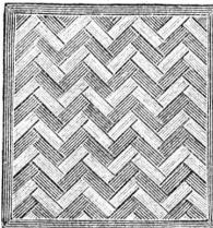
Vissé sur faux ou vieux plancher, rendu posé au bain de mortier de silicate de soude sur béton en ciment Portland, ou béton en scorie, selon tous les dessins : carré, octogones, etc., en quatre couleurs et en forme de foulées (lâtons rompus).
