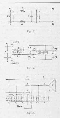
$L_2$  sont accouplés sur le transformateur  $T_1$  aux points A et B, comme cela est indiqué sur la figure 6. Les bobines de self L sont intercalées sur chacun des deux conducteurs, qui sont en outre reliés à la terre par un condensateur C. Comme le courant ne s'amorce pas en  $e_2$ , il est évident que le dispositif protecteur, bobines de self L et condensateurs C, a complètement suffi pour maintenir en ce point la tension normale envers la terre.
