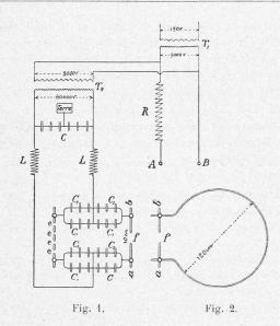
Les figures 2, 3, 4 et 5 sont les schémas d'expériences greffées en a b sur le dispositif ci-dessus et destinées à rendre visibles les effets des courants à haute fréquence.
