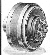
pour l'embrayage et le débrayage d'une série d'arbres ou de machines uniques pendant la marche. Disposition complètement fermée de l'appareil; utilisable pour un grand nombre de tours; graissage automatique des parties intérieures de l'appareil.
