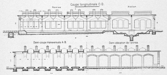
Fig. 4 et 5. — Remise à locomotives de la gare de Renens. — Échelle 1:400.
