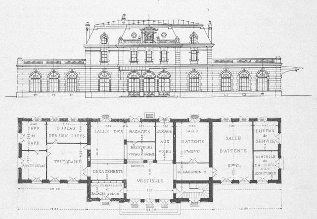
Fig. 2 et 3. — Gare de Renens. — Façade sur cour et plan du futur bâtiment aux voyageurs. — Echelle 1:300.
