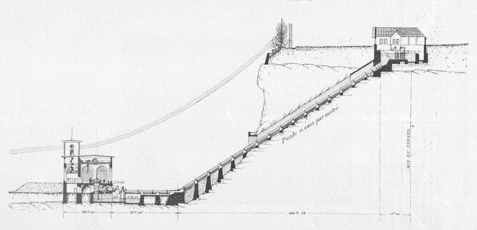
Fig. 41. — Coupe sur le bâtiment de mise en charge et l'usine, suivant l'axe du tunnel des conduites forcées. Echelle ; 1 : 745,
