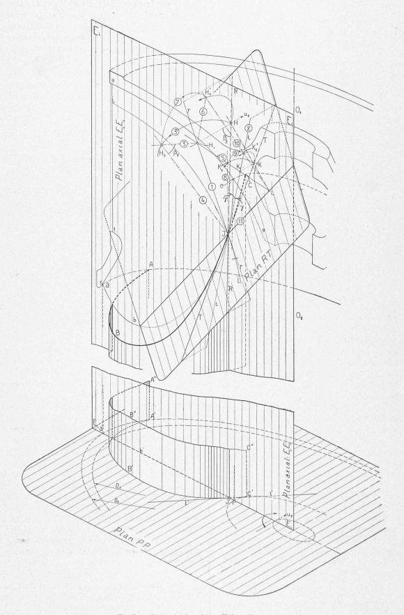
Fig. 3. — Détermination du coefficient d'ouverture  $\psi_{2i}.$  (Errata : Lire  $\beta_{2i}$  au lieu de  $\beta_{2}$  ).
