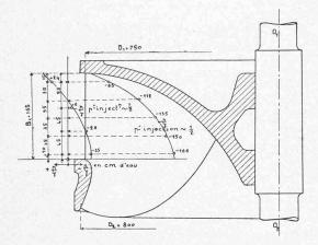
Fig. 2. — Turbine de Beraun. Courbe des pressions  $\frac{p}{\gamma}$
