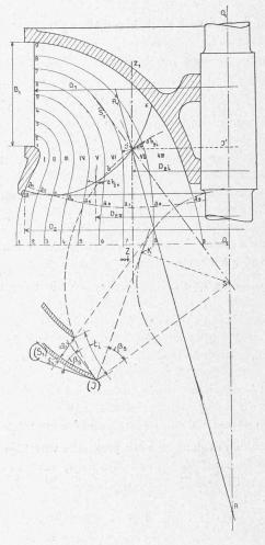
Fig. 1. — Turbine hélico-centripète.
