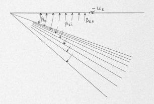
Fig. 6. — Angles de sortie  $\beta$ 21,  $\beta$ 22,  $\beta$ 28.
