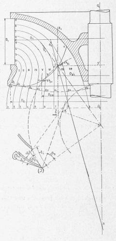
Fig. 1. — Turbine hélico-centripète.
