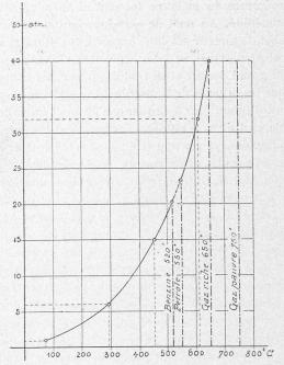
Fig. 5. — Courbe des températures de la compression adiabatique.
