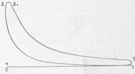
Fig. 8. — Diagramme d'essai d'un moteur Diesel.
