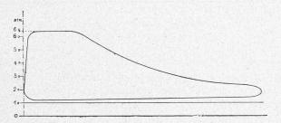
Fig. 2. — Diagramme du moteur de Gardie 1.
