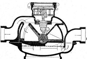
Compteurs d'eau à ailettes Compteurs d'eau à disques; Compteurs d'eau pour étages; Compteurs d'eau pour hydrants; Compteurs d'eau pour l'alimentation des chaudières;
