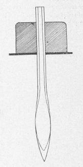
Fig. 2. — Coupe schématique du tube de verre d'un condensateur.
