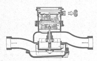
Compteurs d'eau à ailettes Compteurs d'eau à disques; Compteurs d'eau pour étages; Compteurs d'eau pour hydrants; Gompteurs d'eau pour l'alimentation des chaudières;
