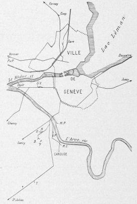
Fig. 9. — Plan des lignes à voie étroite de Genève sur lesquelles circulent les trucs-transporteurs.
