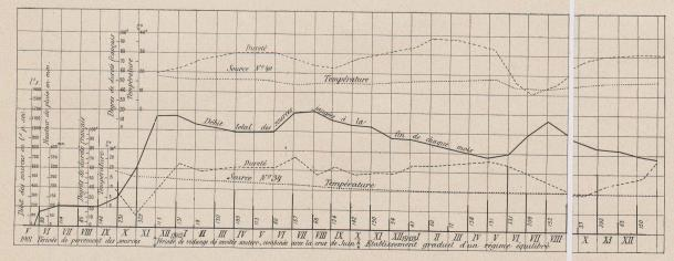
Fig. 42. — Diagramme des variations du débit total des sources froides d'Iselle, entre les km. 3,860 et 4,421, comparées à la quan de pluie, à la température et à la dureté des eaux.
