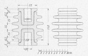
Fig. 8. — Isolateur employé à l'intérieur pour les connexions à 40 000 volts.
